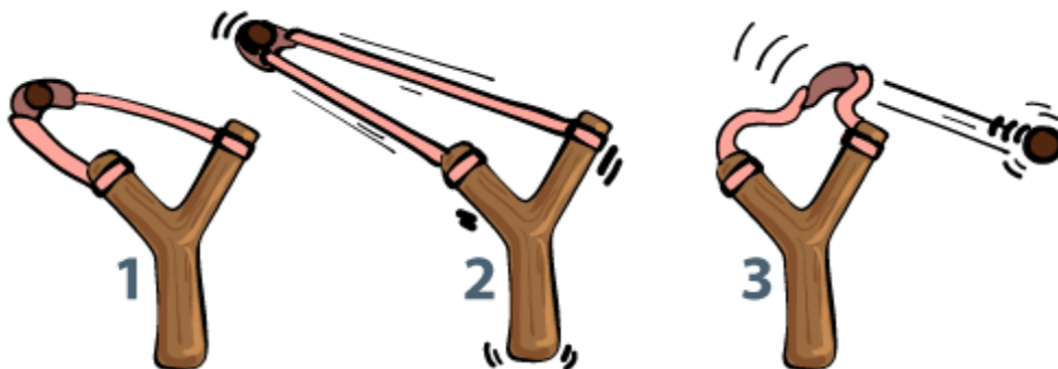
Slika 1: Ob napenjanju elastike opravimo delo, ki se shrani kot prožnostna energija.
